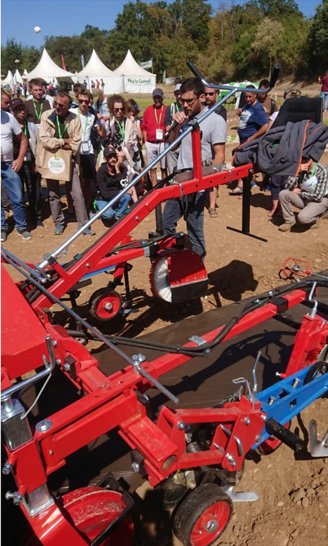
*Démonstration du matériel de binage à brosses des passes-pieds en bords de paillages de Terrateck. Prix 3200 € (remplacement des brosses en cas d'usure : 70 € par côté).*
